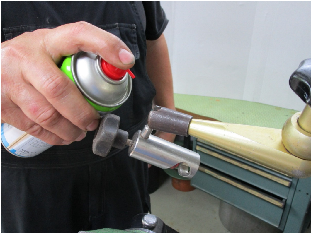
15) Beide Gelenkkugeln reinigen und entfetten.
