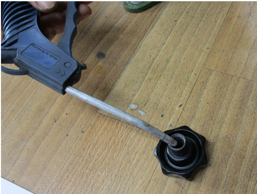
13) Handrad trocknen lassen (ggf. mit Druckluft)
