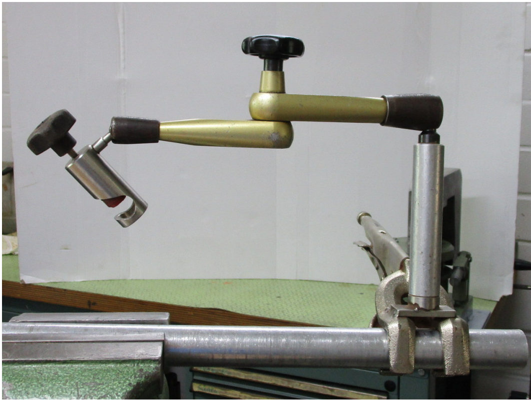
2) Vorbereitung: Rohrzange fixieren, Stativ einrasten
